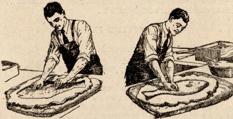
FIG. 2 et 3. — Phases successives du moulage.
