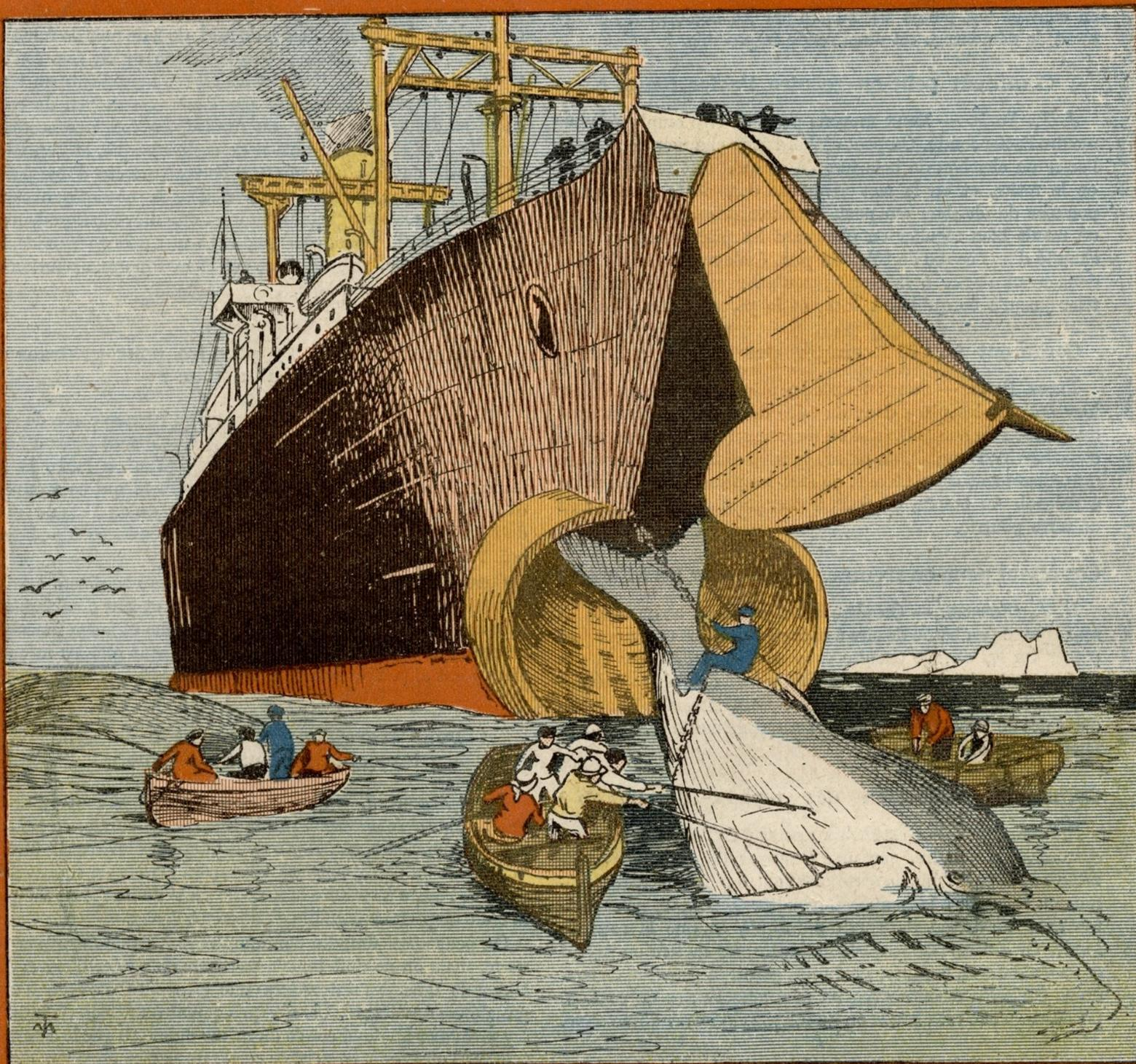
Navire baleinier moderne, avec dispositif permettant le dépeçage à bord.
